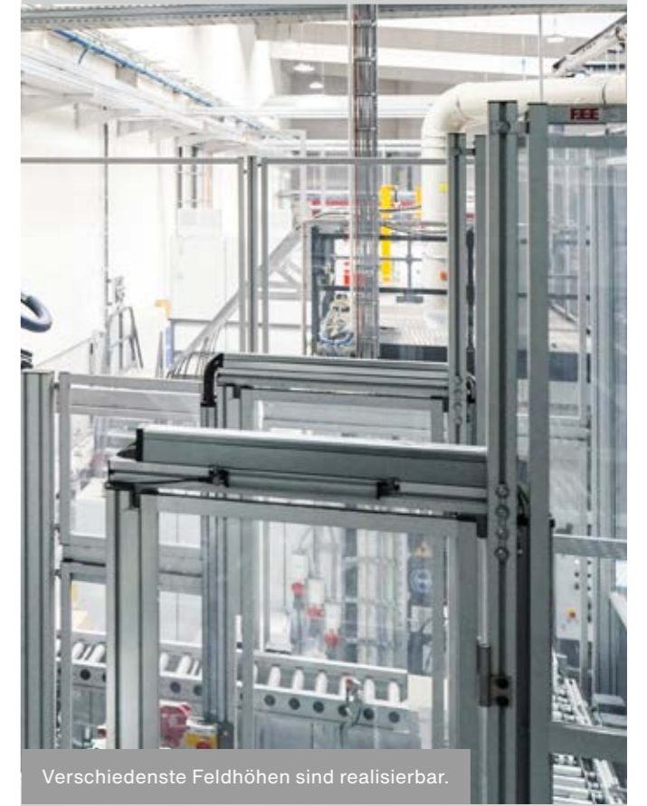
Einfachtür mit Verriegelung u. EUCHNER-Sicherheitsschalter.
