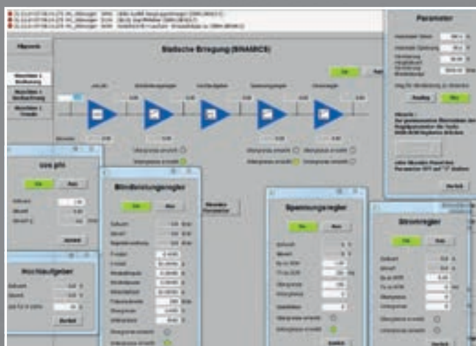
Parameterfenster einer statischen Erregereinrichtung.
