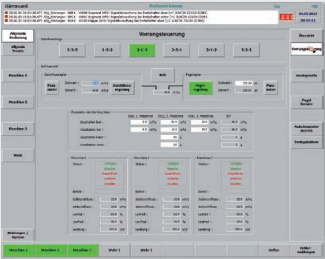
Abb. 6: B&B Vorrangsteuerung der Turbinen
