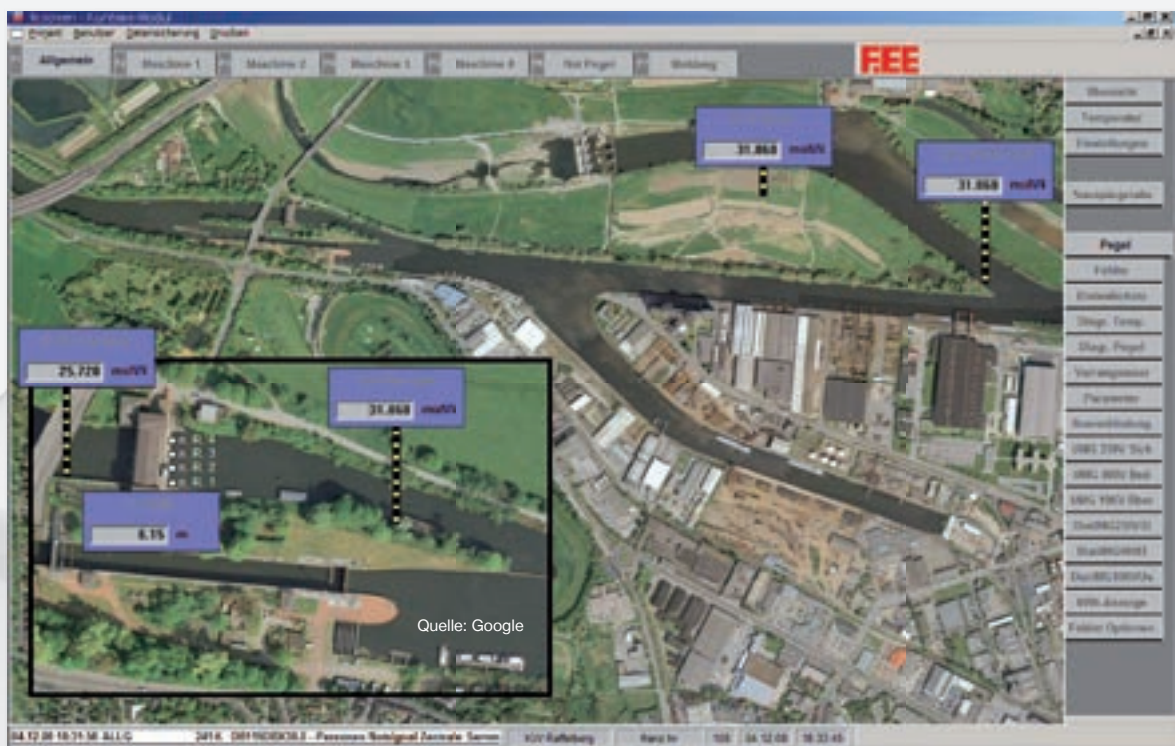
Abb. 5: Pegelübersicht im fe.screen Runtime-Modul
