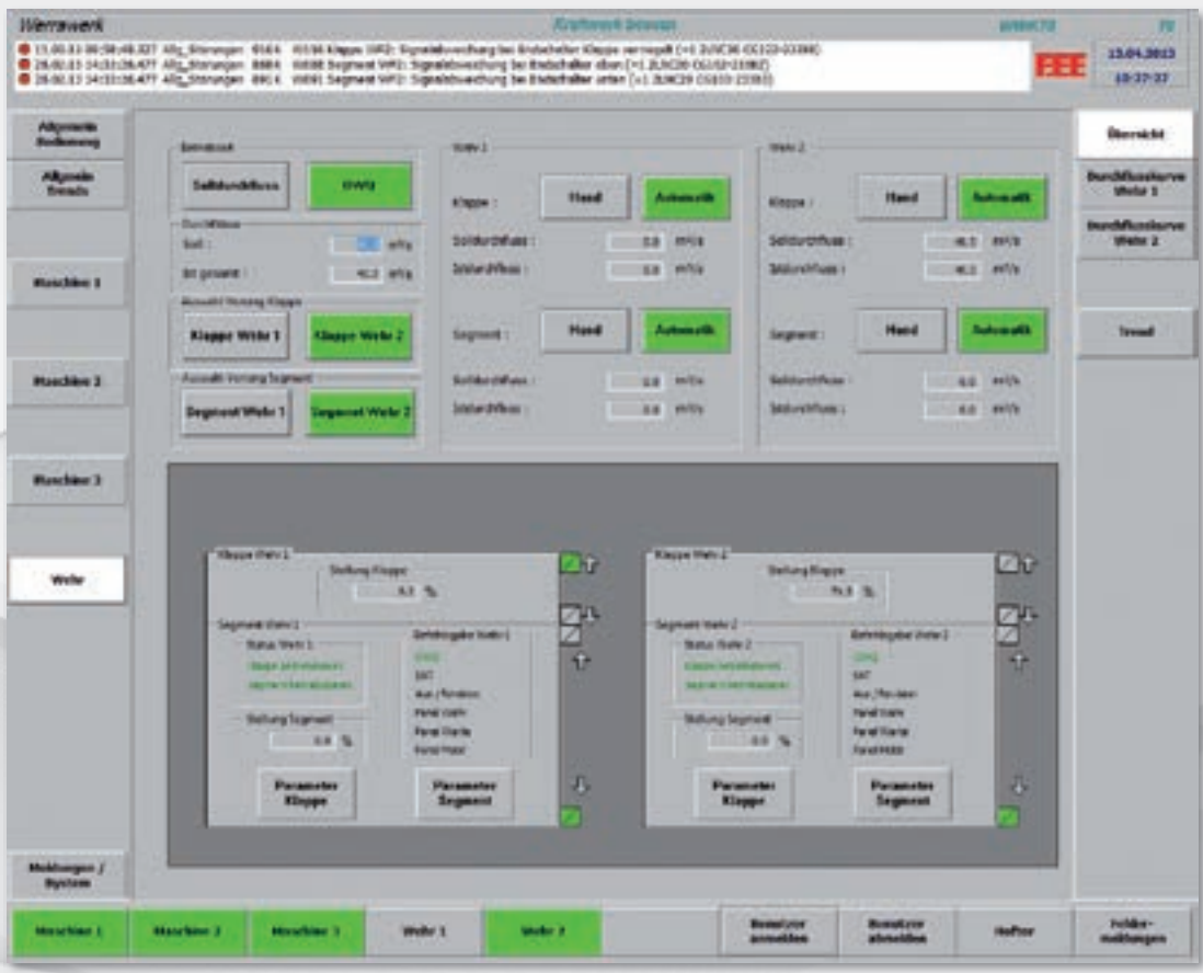
Abb. 7: B&B Steuerung der Segmentschütze und Wehrklappen
