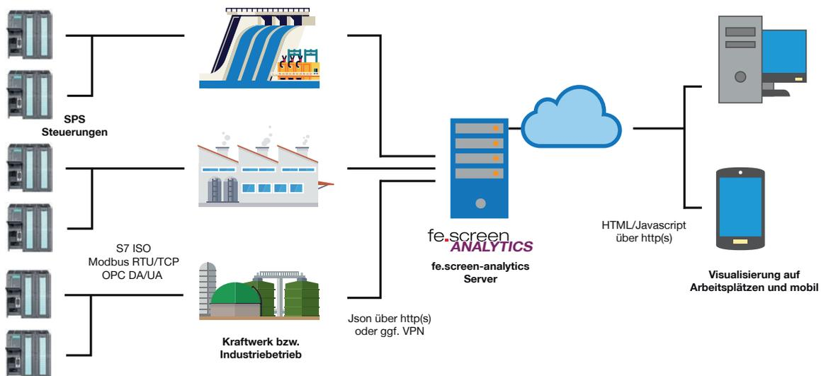
Schematische Darstellung der Datenerfassung und Visualisierung in fe.screen-analytics.
