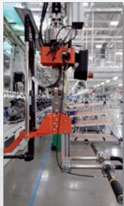
Abb. 5 und 6: Handgeführte Schraubvorrichtung
