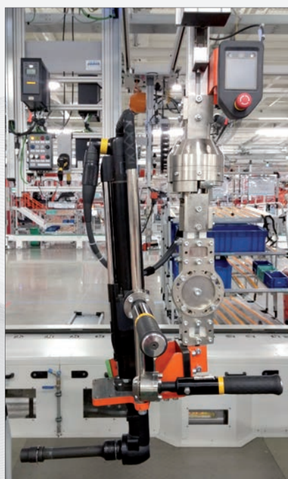
Figuras 5 y 6: Dispositivos de atornillado manual guiado
